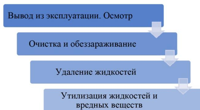
**Рис. 5.** Технологический процесс вывода ВС из эксплуатации (D1)
