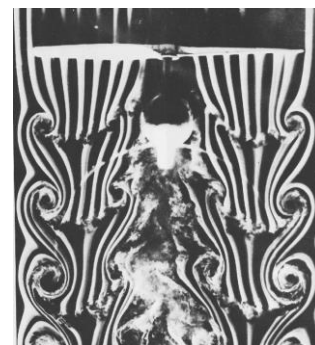
Рис. 5. Движение вихревого следа от лопастей на режиме осевого обтекания винта
