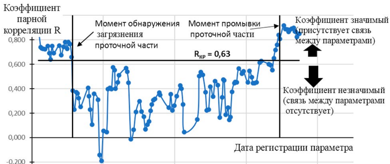
Рис. 7. Динамика изменения коэффициента парной корреляции параметров GPCN25 (отклонение оборотов ротора ВД от базовой линии) и GWFM (отклонение расхода топлива от базовой линии) двигателя 2
