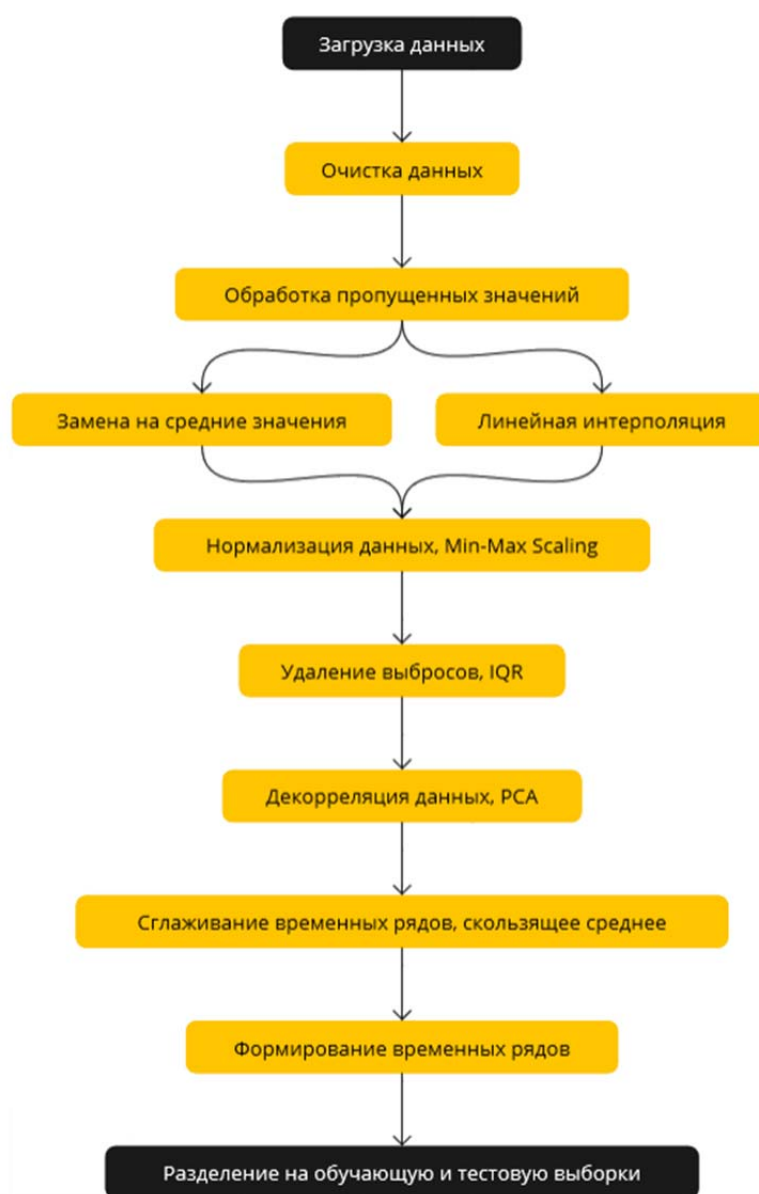
Рис. 2. Схема алгоритмов подготовки данных для создания и обучения моделей нейронной сети Fig. 2. Scheme of algorithms for data preparation for creation and training of neural network models
