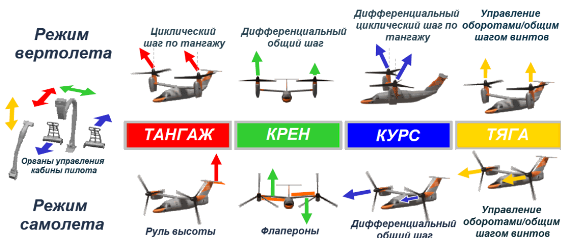
Рис. 7. Каналы управления конвертопланом AW609 Fig. 7. AW609 Tiltrotor Control Axes
