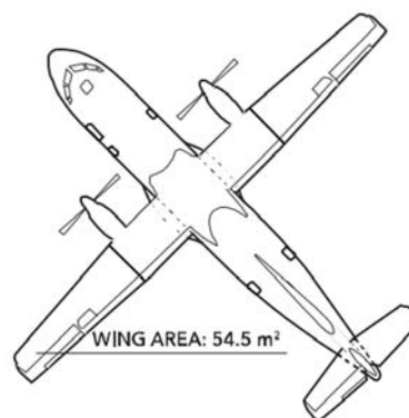
Рис. 3. Схема компоновки крыла самолета ATR 42-600
