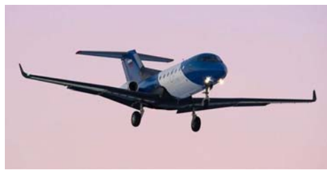
Рис. 2. Самолет СТР-40ДТ с «черным крылом» и с законцовками 5
