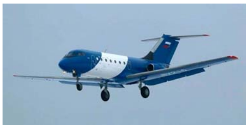
Рис. 1. Самолет Як-40-МС с двумя двигателями Garrett TFE731-3 вместо трех АИ-25 5
