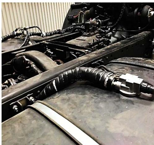
Рис. 11. Обогреватель топливной магистрали без патрубка
