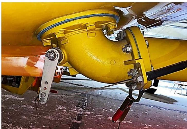
Рис. 7. Механический донный клапан
