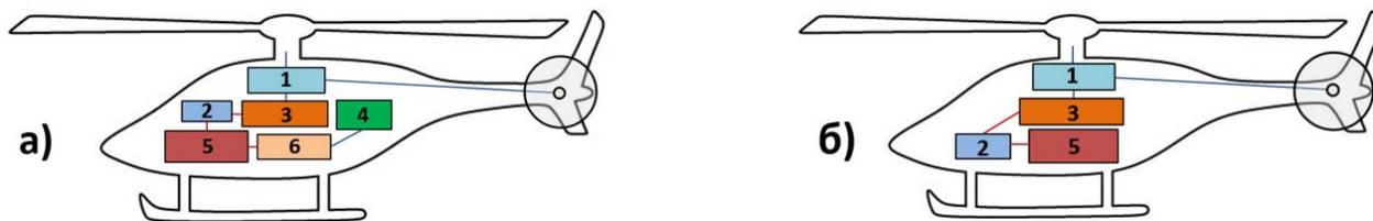
Рис. 1. Основные элементы СУ одновинтового вертолета с гибридной (а) и полностью электрической (б) силовой установкой
