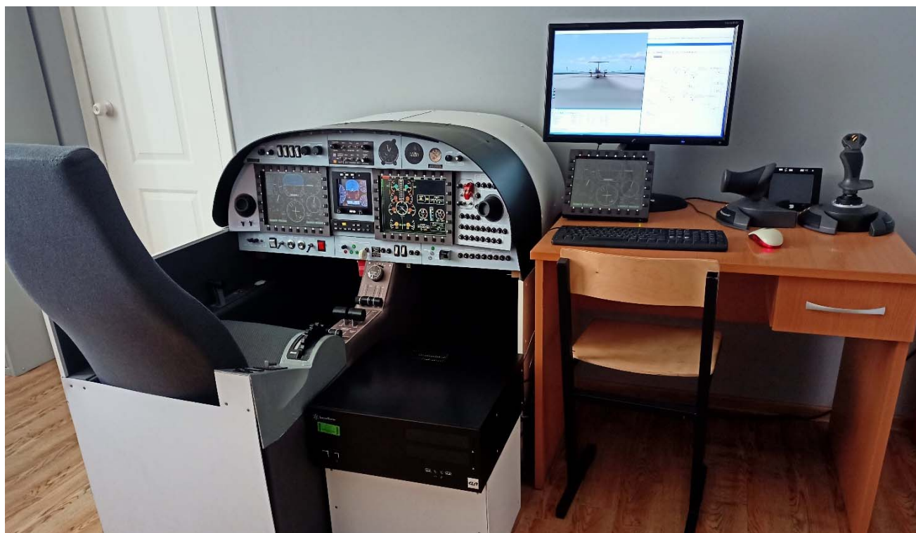
Рис. 11. Разработанный интерактивный макет кабины экипажа самолета ДА-42Т Fig. 11. Developed interactive DA-42T aircraft cockpit mockup
