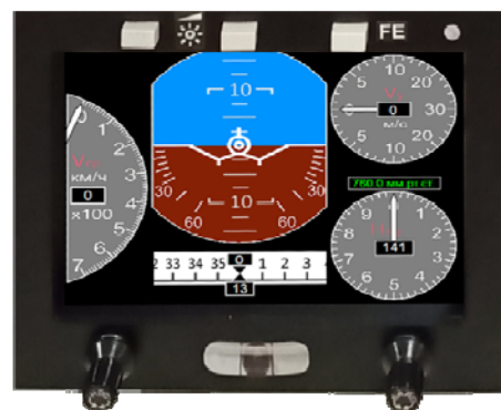
Рис. 4. Имитаторы основного (а) и резервного (б) МФИ Fig. 4. Simulators of the primary (a) and backup (б) MFI
