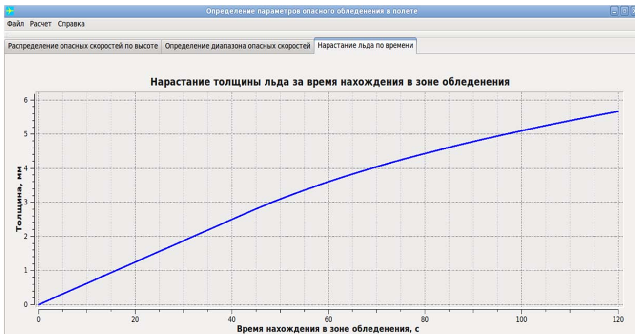
Рис. 4. Зависимость толщины льда от времени экспозиции Fig. 4. Dependence of ice thickness on exposure time
