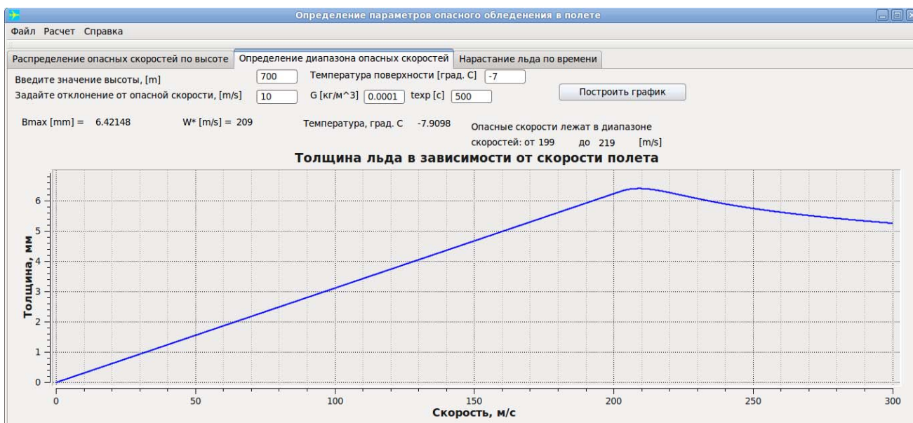
Рис. 3. Определение диапазона опасных скоростей полета Fig. 3. Determination of the dangerous flight speeds range
