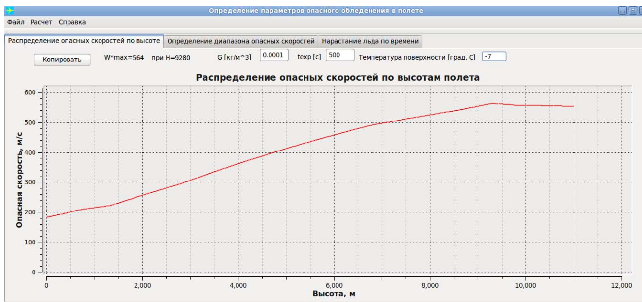
Рис. 2. Распределение опасных скоростей по высоте полета Fig. 2. Flight altitude dangerous velocities distribution
