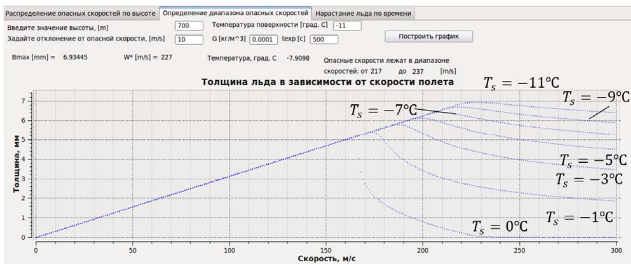
Рис. 5. Влияние температуры поверхности на зависимость толщины льда от скорости на высоте 700 м Fig. 5. Surface temperature influence on dependence of ice thickness on high speed at 700 m altitude
