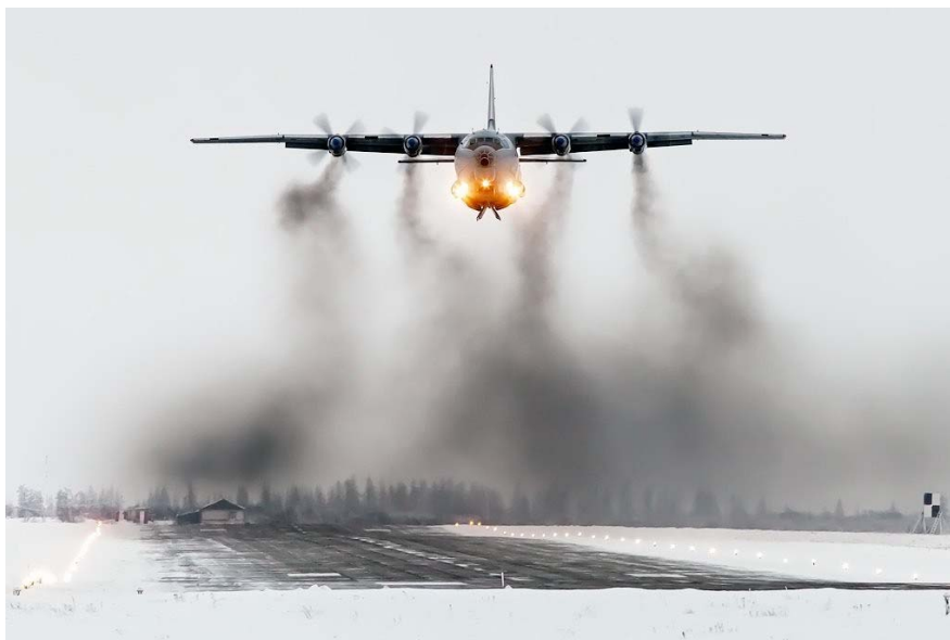
Рис. 1. Случайная визуализация вихревого следа за турбовинтовым самолетом Ан-12 при взлете Fig. 1. Random visualization of the wake vortex following the Antonov-12 turboprop aircraft during takeoff
