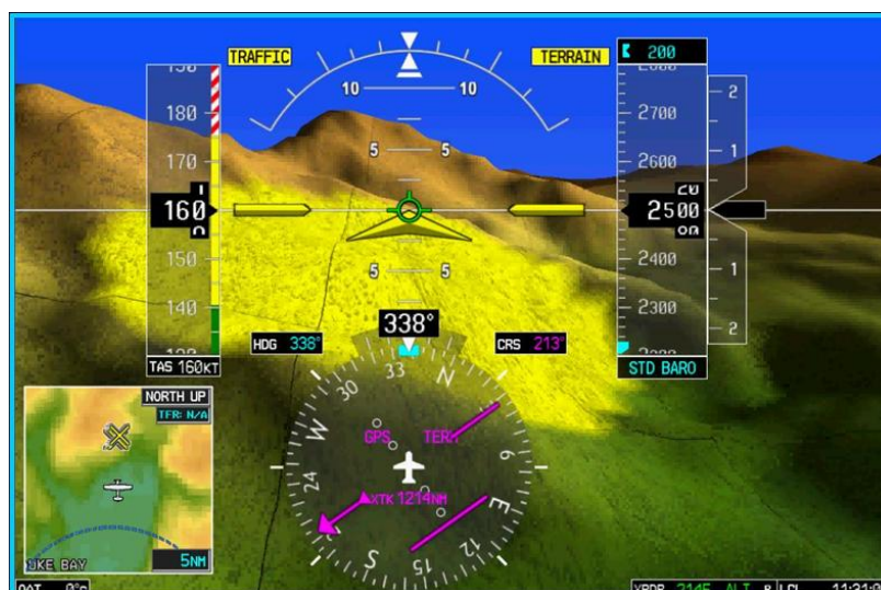
Рис. 8. Пример отображения системы синтетического видения в комплексе компании Garmin Fig. 8. Example a synthetic vision system display in the Garmin suite
