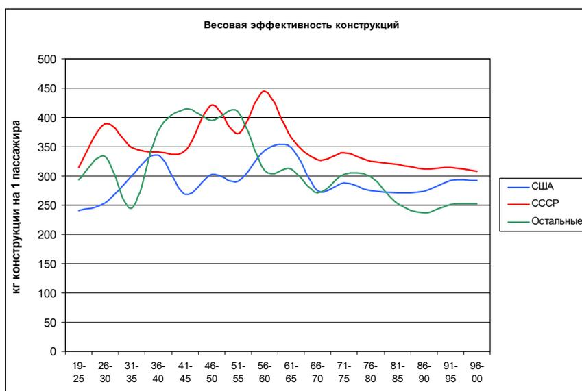
**Рис. 10.** Изменение массы конструкции пассажирского самолета в расчете на одного пассажира, кг
