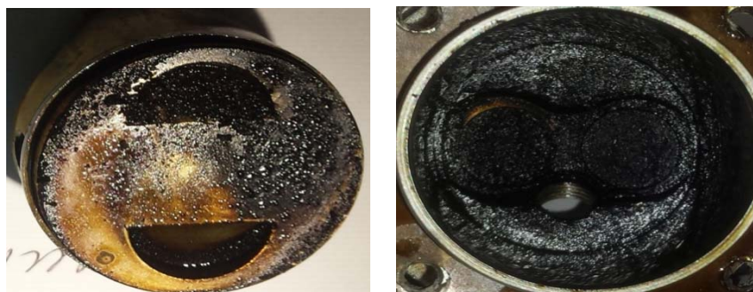
Рис. 1. Вид поршня бензинового двигателя Saito GI-36 1 после эксплуатации на масле с низким уровнем антинагарных свойств
