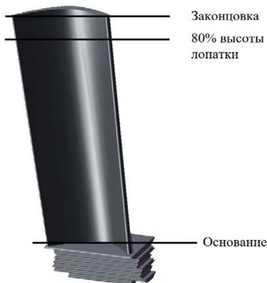
**Рис. 1.** Схема сечений вырезки образцов из лопатки для металлографического исследования
