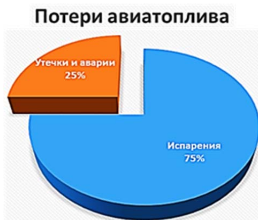
Рис. 1. Статистика потерь авиатоплива в ТЗК в результате малых и больших дыханий резервуаров Fig. 1. Statistics of jet fuel losses in the refueling complex due to “insignificant and strong breathing of tanks”
