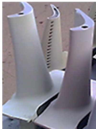
Рис. 3. Внешний вид покрытия лопаток после сушки при температуре 50...70 °С – 15 минут Fig. 3. Appearance of the blade coating after drying at a temperature of 50...70 °C – 15 minutes
