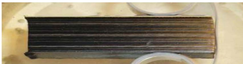
Рис. 1. Разрез 33-слойного композита с окрашенной поверхностью
