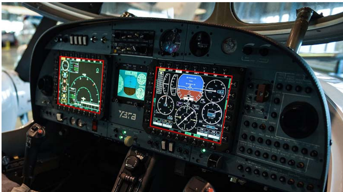
Рис. 1. Информационные кадры центральной информационной системы на многофункциональных индикаторах в самолете ДА-42Т
