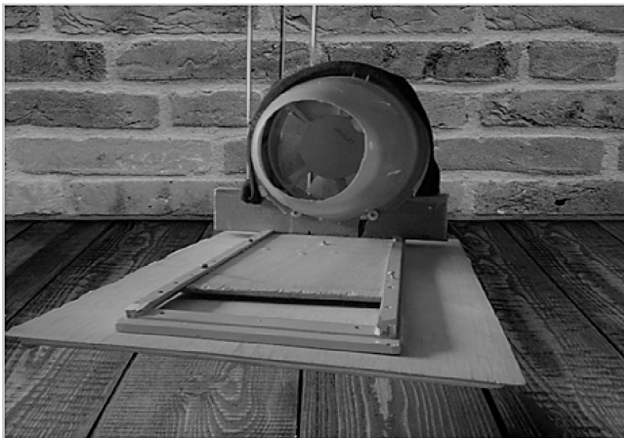
Рис. 2. Генератор на основе осевого вентилятора с конфузоров для увеличения скорости воздушного потока Fig. 2. A generator based on an axial fan with a confuser to increase the air flow velocity
