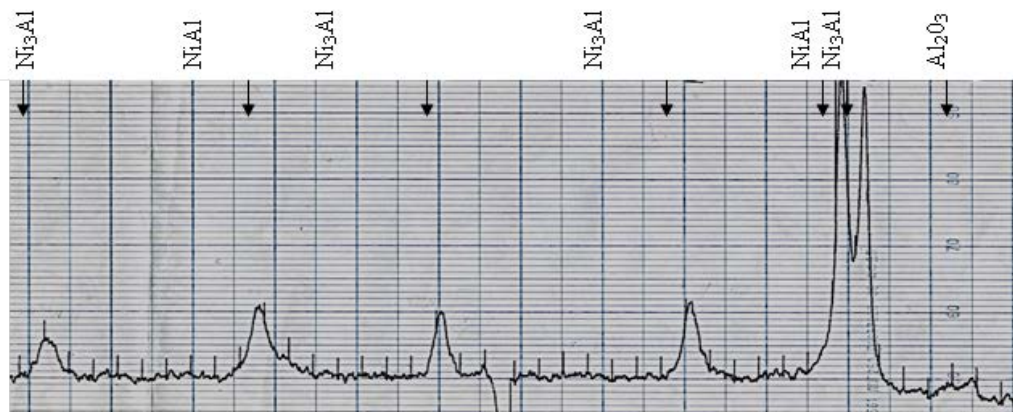
Рис. 2. Дифрактограмма фазового состава сплава ЖС26ВСНК с комплексным покрытием толщиной 20 мкм
