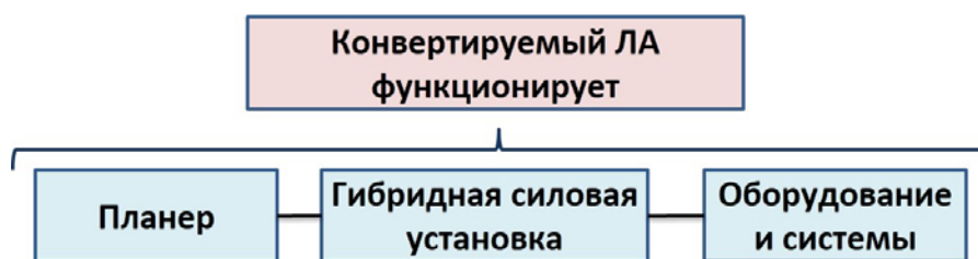
Рис. 6. Структурная схема верхнего уровня для конвертируемого ЛА
