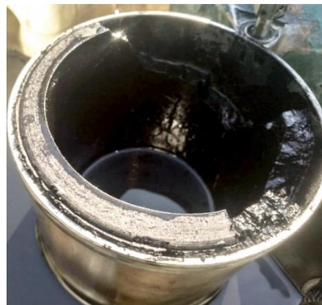
Рис. 3. Центрифуга ТЦМ-25 после 100 часов работы двигателя
