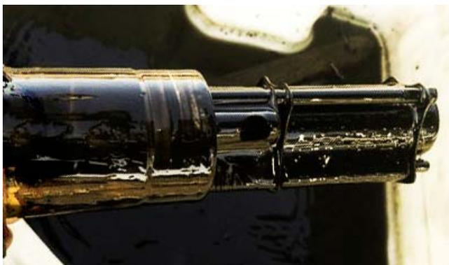
Рис. 2. Фильтр МФМ-25 после 1,5 часов работы двигателя
