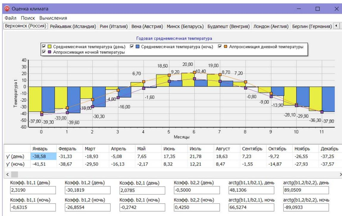
Рис. 5. Сезонные колебания температуры воздуха на основании тригонометрической модели
