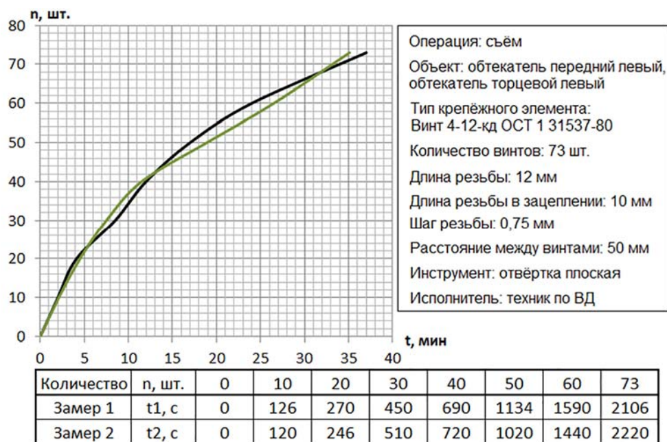
Рис. 3. Таблица и графики замеров непрерывного снятия 73 винтов переднего левого и торцевого левого обтекателей консоли вертолета Ка-226Т
