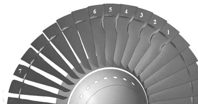
Рис. 9. Количество поврежденных рабочих лопаток первой ступени КНД во втором тестовом случае
