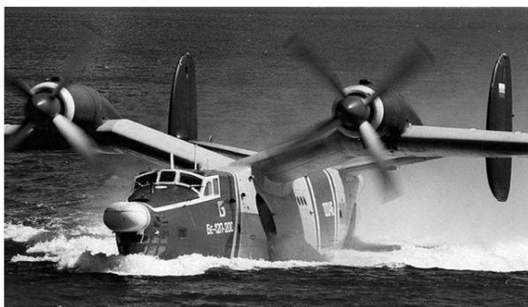
Рис. 1. Самолет-амфибия Бе-12 на режиме плавания
