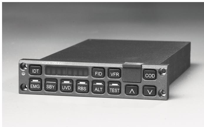
Рис. 2. Внешний вид пультового ответчика СО-2010
