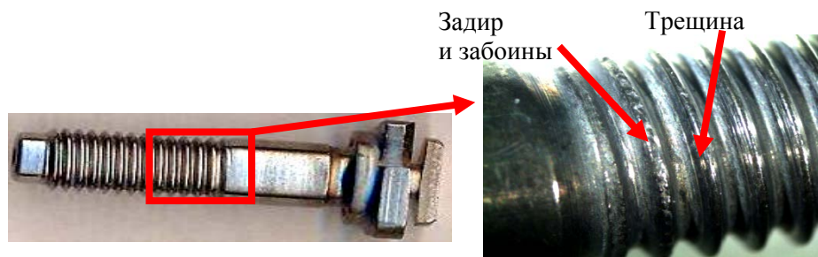
Рис. 1. Внешний вид болта с дефектами после эксплуатации и демонтажа Fig. 1. The appearance of bolt defects after operation and dismantling
