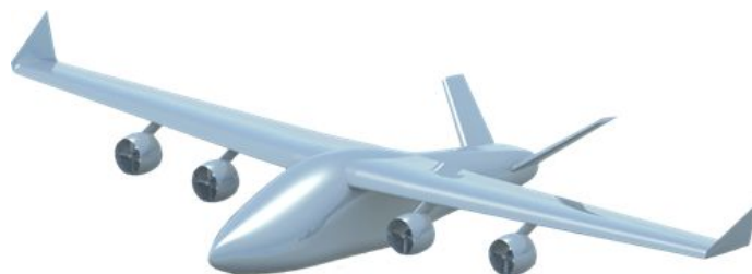
Рис. 2. Концептуальная трехмерная модель полностью электрического самолета АВФ-32НС Fig. 2. Conceptual three-dimensional model of the all-electric aircraft AVF-32NS
