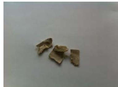
**Рис. 3.** Образцы, вырезанные из разных слоев фильтроэлемента
