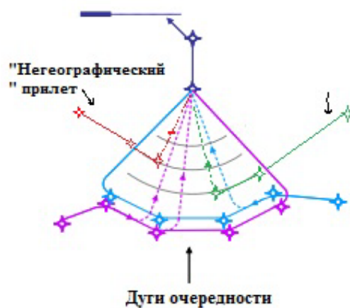
Рис. 1. Пример схемы «Веер» (расстояние между дугами 10 км)
